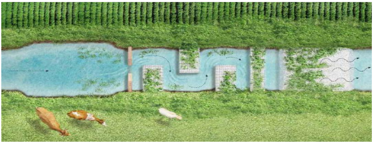
Slika 1: Tloris grajenega ekosistema (usedalnik, odsek meandriranja in na koncu čistilna grada s podpovršinskim tokom vode)
