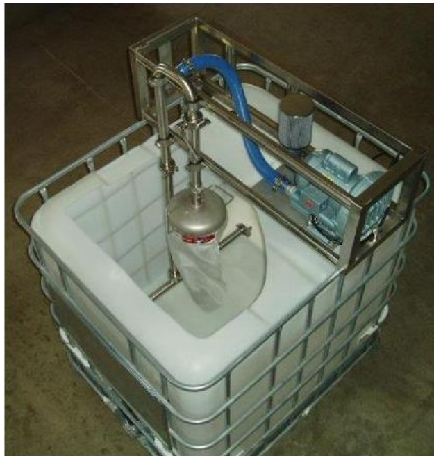
Slika 1: Cisterna predelana v napravo za kompostni čaj. Na sliki je vidna zračna črpalka in najlonsko cedilo, v katero damo kompost
