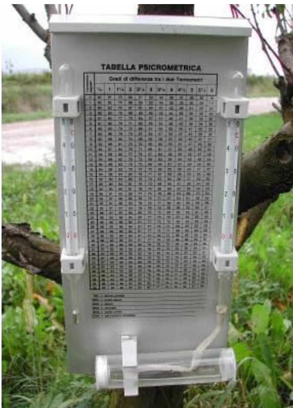
Slika 20: Psihrometer: mokri in suhi termometer
