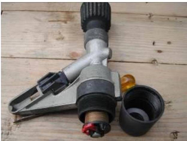
Slika 29: Odstranimo kapico in varovalko, zategnemo vzmet in ponovno namestimo varovalko in kapico.
