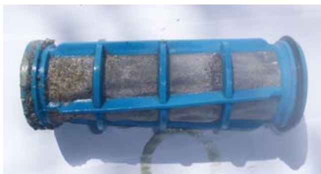
Slika 82: Nečistoče na tlačnem filtru
