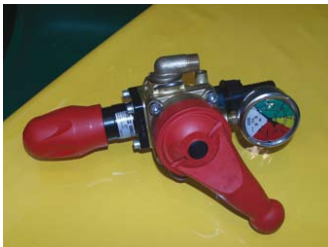
Slika 79: Krmilni mehanizem – mehanski
