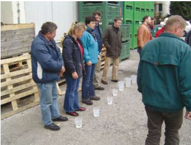
Slika 87: Merjenje pretoka šob s pomočjo merilnih vrčev
