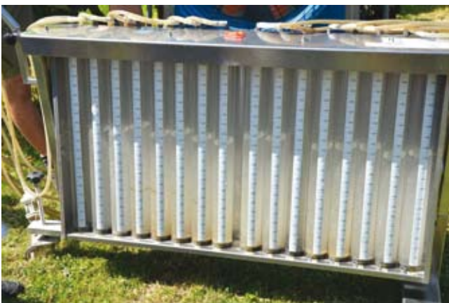
Slika 88: Merjenje pretoka šob s pomočjo merilne naprave
