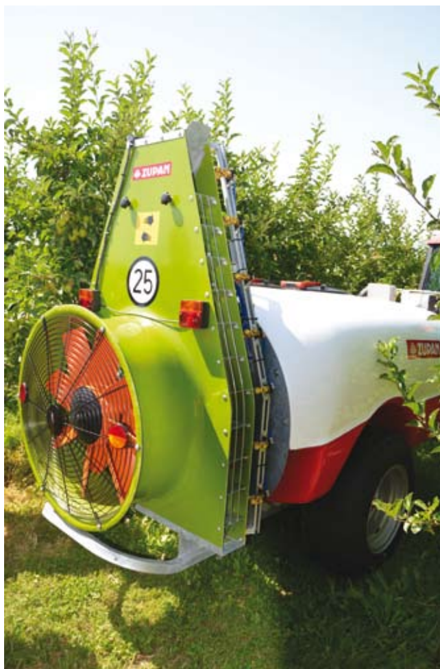
Slika 89: Primer pršilnika z aksialnim puhalom
