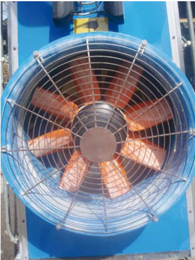
Slika 83: Škropilna obloga na ventilatorju lahko sčasoma povzroči ropot ležajev
