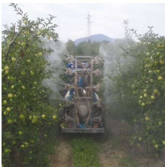
Slika 90: Primer delovanja pršilnika z radialnim ventilatorjem
