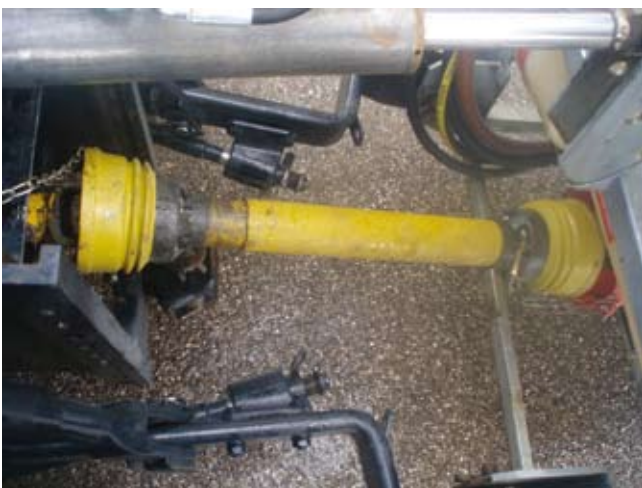
Slika 84: Pravilno zaščiten priključna gred na pršilniku
