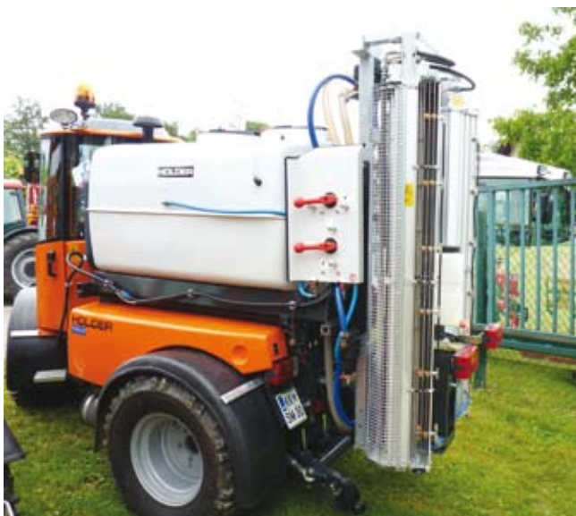
Slika 91: Primer pršilnika s tangencialnim ventilatorjem
