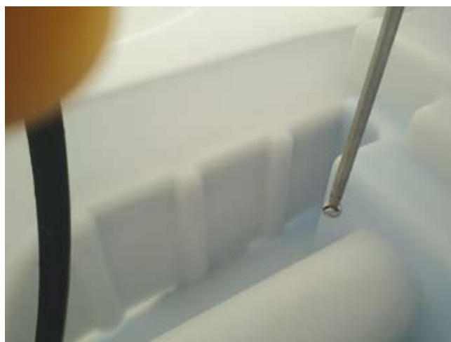
Slika 78: Šoba za notranje čiščenje rezervoarja
