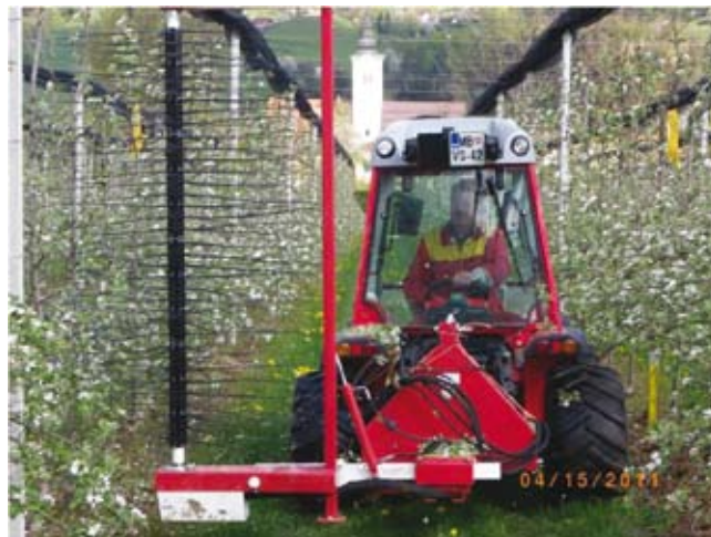
Slika 41: Darwin – naprava za strojno mehansko redčenje
