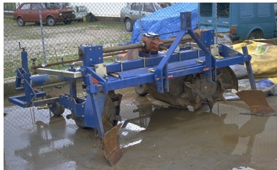
Slika 9: Rotacijski gredičar za izdelavo grebenov pri pridelavi belušev
