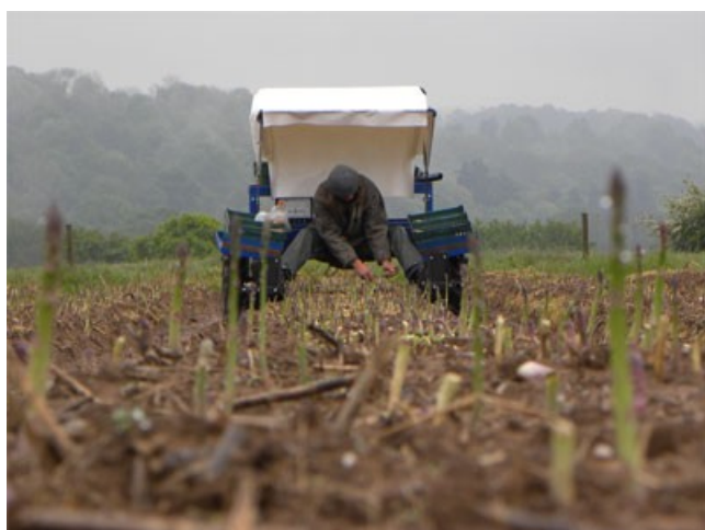
Slika 10: Električni voziček za prevoz pobiralca in zabožkov s šparglji po nasadu med pobiranjem.
