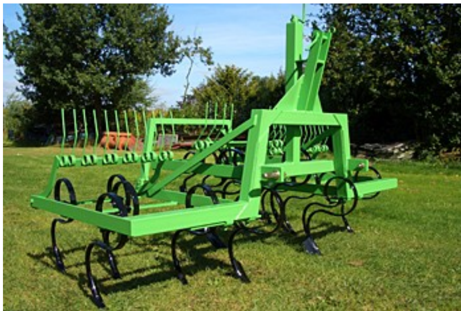
Slika 15: Medvrstni vlečeni okopalnik, rahljalnik za mehansko zatiranje plevelov in zračenje tal. Dvignjeni sredinski del omogoča medvrstno obdelavo z vožnjo preko grebena obeljenih špargljev tudi v času spravila.
