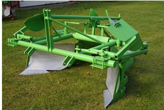
Slika 8: Plužni gredičar za izdelavo grebenov pri pridelavi belušev in nižjih opornih grebenov, ki jih napravimo po koncu sezone spravila pri pridelavi zelenih špargljev
