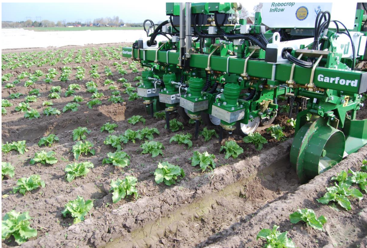
Slika 9: Robocrop – omogoča zatiranje plevela v vrsti ter v medvrstnem prostoru
