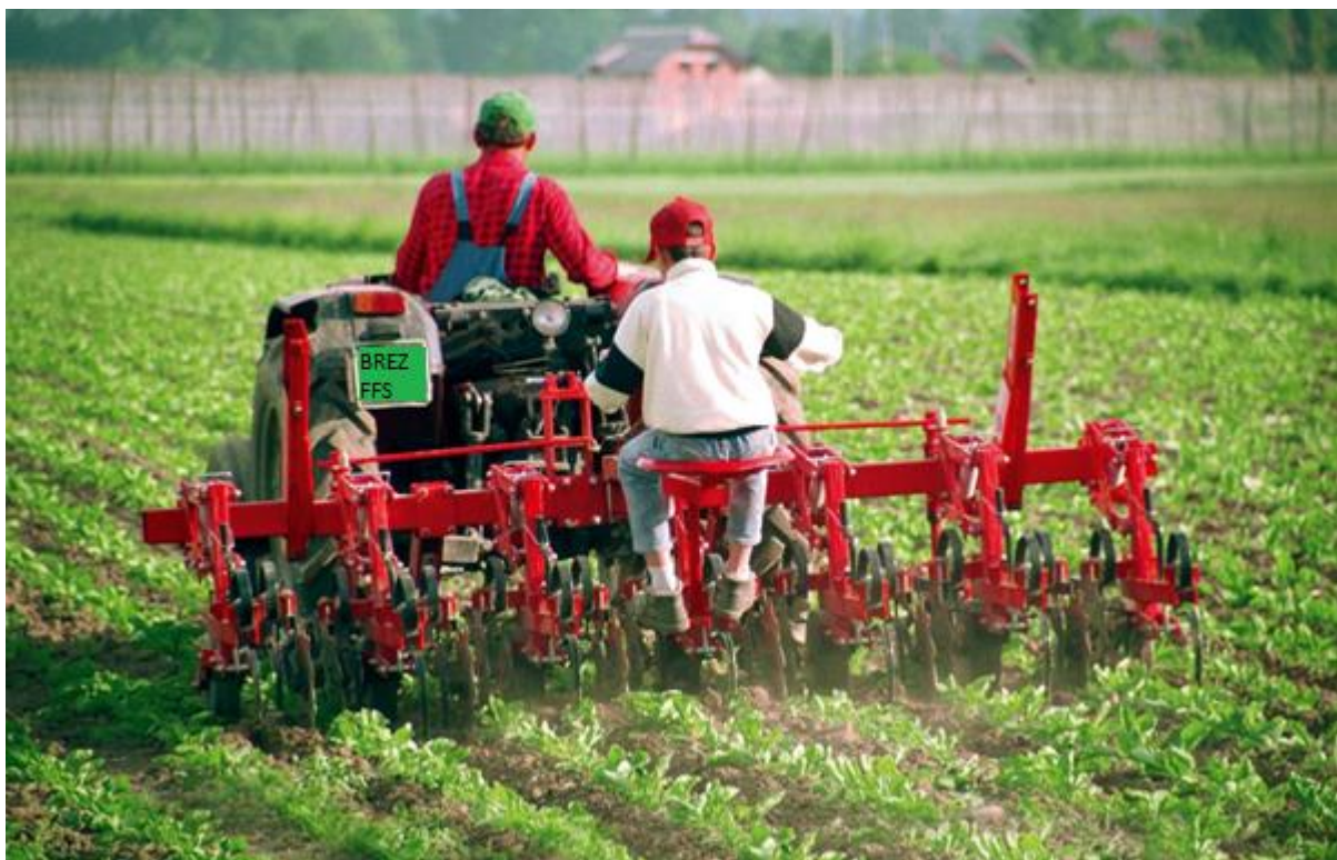
Slika 3: Mehansko zatiranje plevla z medvrstnim okopalnikom
