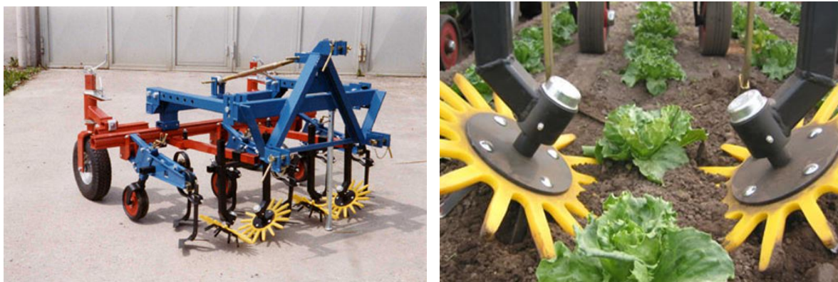
Slika 7 in 8: Prstni okopalnik s prikazom delovnih elementov
