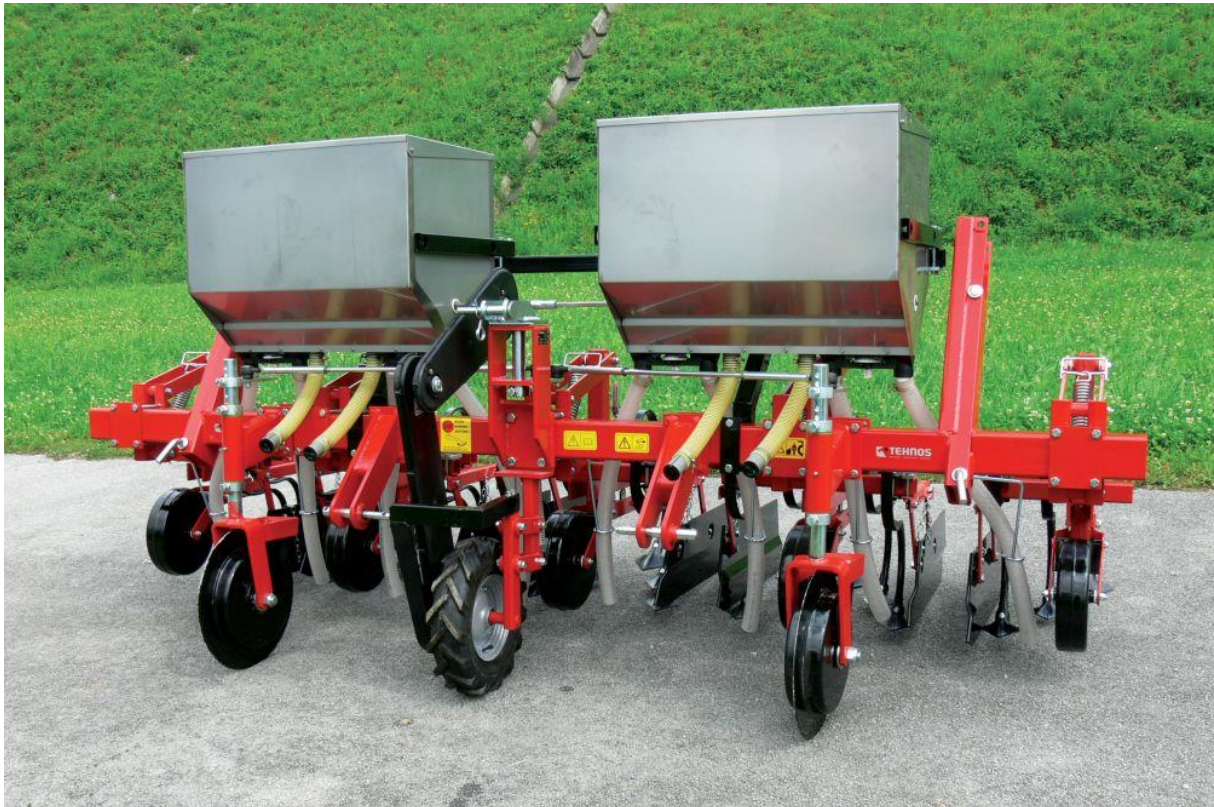
Slika 10: Dognojevanje z mineralnimi gnojili lahko izvedemo z uporabo medvrstnega okopalnika, ki ima nameščeno napravo za dognojevanje
