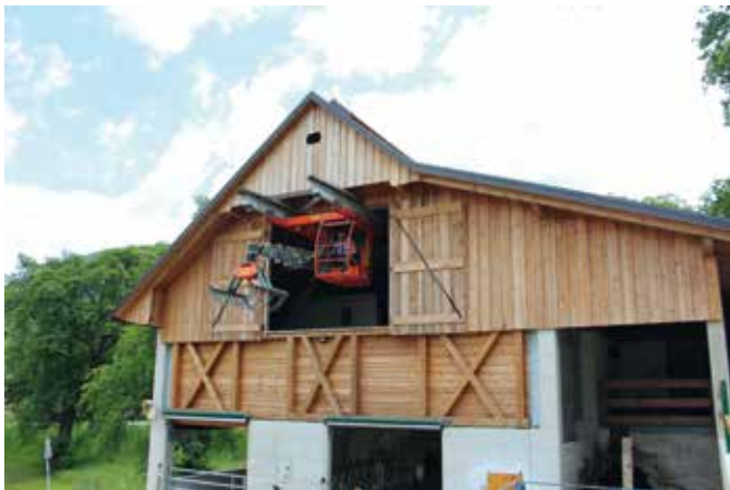
Tirni grabež je osrednji del obnovljenega hleva, okrog katerega so uredili hleve in senik.
