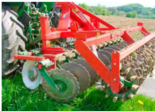
Krožne brane z zgoščevalnimi valji
