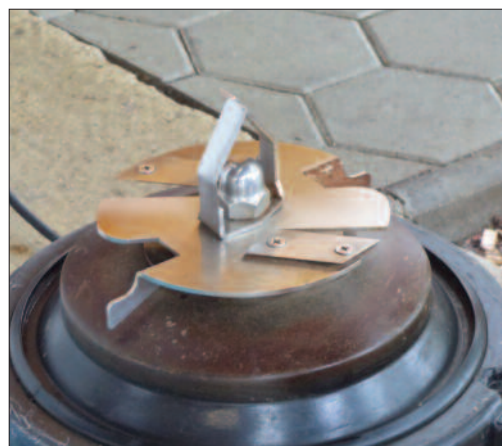
Rezila na mlinu morajo biti ostra, da so delci sadne kaše čim manjši (1–2 mm).
