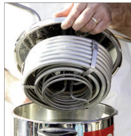
Cevni pasterizator – na obodu sta dve vrsti spiralnih cevi, v notranjosti pa je električni cevni grelec.
